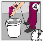
Для подготовки раствора залейте водопроводную воду комнатной температуры в чистую ёмкость из расчёта 4,5 - 5,5 л воды на 1 мешок (25кг). Засыпая сухую смесь в воду, перемешивайте раствор дрелью со специальной насадкой на низких оборотах до получения однородной массы. Подождите 5 минут, после этого перемешайте вторично. Время пригодности раствора к работе не менее 3 часов.
